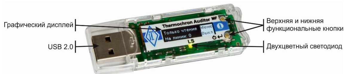
Рисунок 1 – Вид прибора с элементами подключения и индикации
