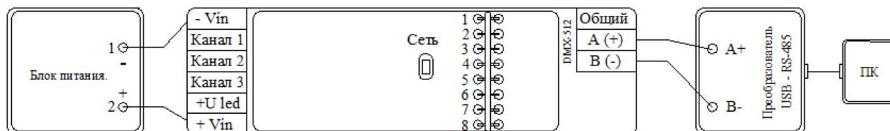
Рисунок 10 – Подключение контроллера КЗ-DMX к компьютеру.
