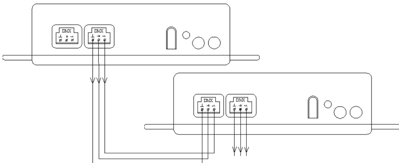
Рисунок 18 – Подключение контроллера K16-DMX в режиме «Мастер».
