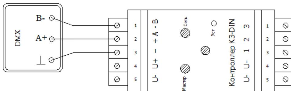
Рисунок 12 – Подключение контроллера КЗ-DIN к линии DMX-512.
