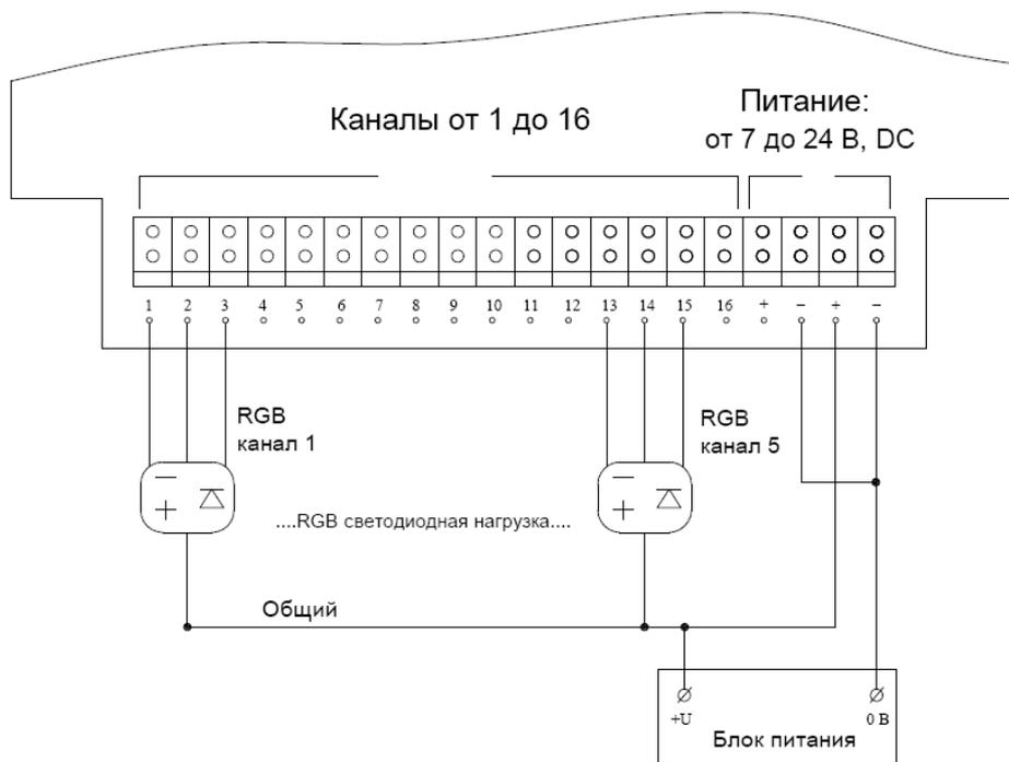
Рисунок 16 – Подключение K16 и K16-DMX к трехканальным (RGB) источникам света.
