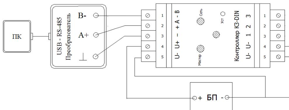
Рисунок 13 – Подключение контроллера КЗ-DIN к компьютеру.
