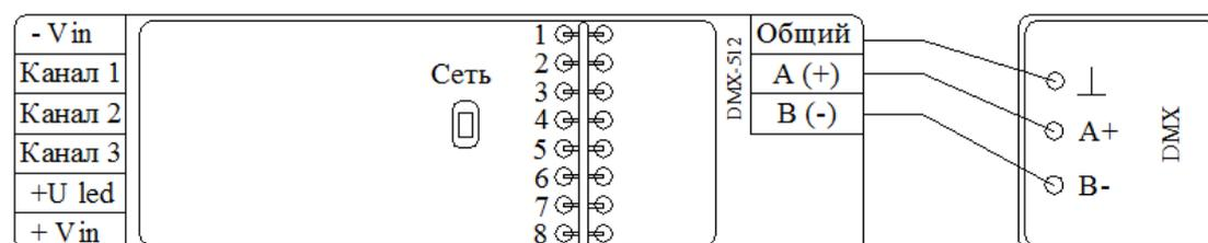
Рисунок 9 – Подключение контроллера КЗ-DMX к линии DMX-512.
