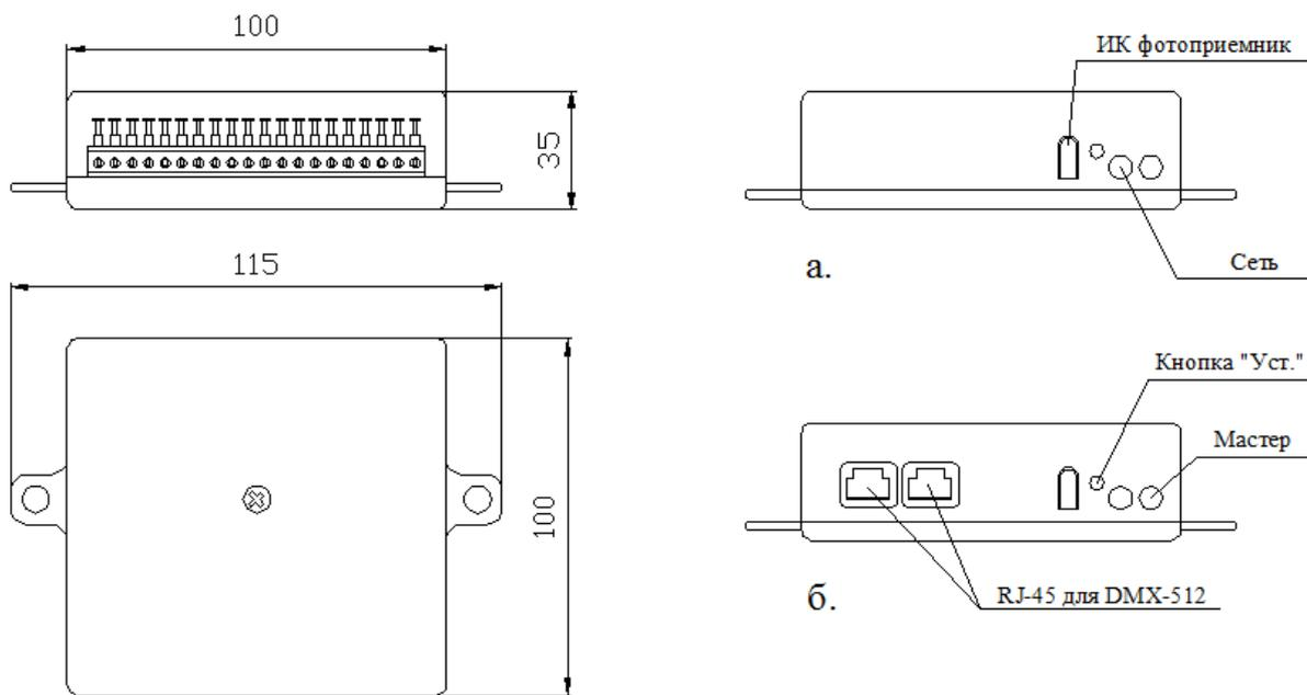
Рисунок 4 – Внешний вид и габаритные размеры контроллеров K16 (а) и K16-DMX (б).
